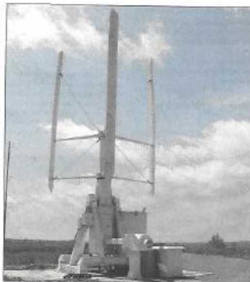
Il s'agit d'un concept innovant d'éolienne à axe vertical, capable d'apprivoiser les vents marins.
