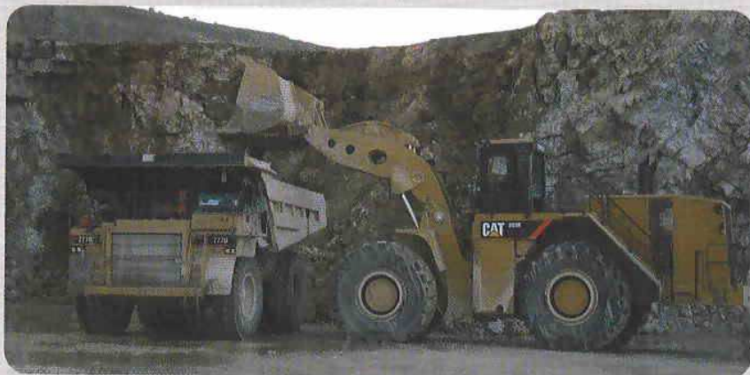
La chargeuse à pneus 993 K possède un godet capable de saisir 25 t de matériau. Le chargement du tombereau d'une capacité d'accueil de 100 t se fait en quatre passes.
