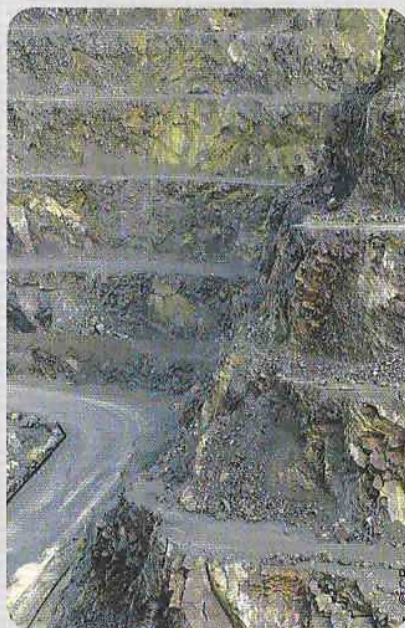
Les fronts de taille dans la carrière de Ferques s'élèvent à 15 m de hauteur.
